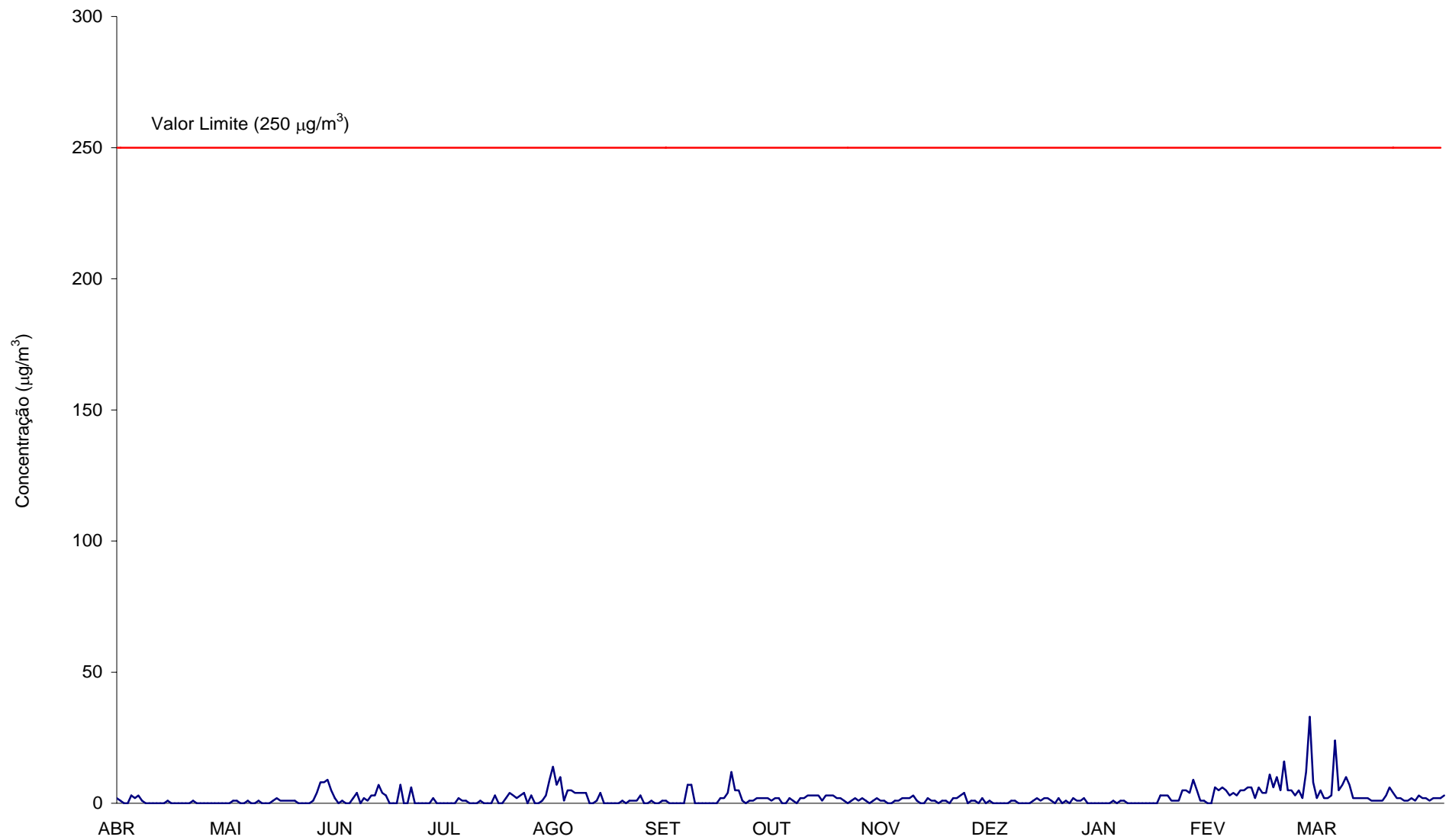
Gráfico 15 - Médias diárias das concentrações de SO 2 (µg/m 3 ) registadas em Avanca segundo a Portaria nº 286/93, 12 de Março (Abril de 2003 a Março de 2004).
