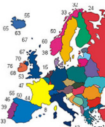
Figura 67: Recurso europeu (valores em kW/m de frente de onda) Fonte: Ocean Power Delivery - 2006
