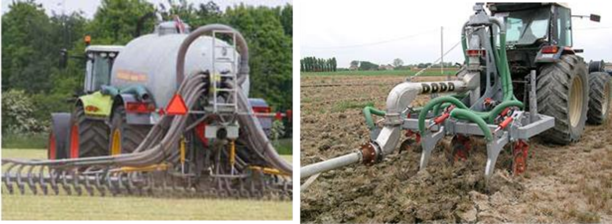
Fig. 25 - Equipamento de injeção direta de chorume
