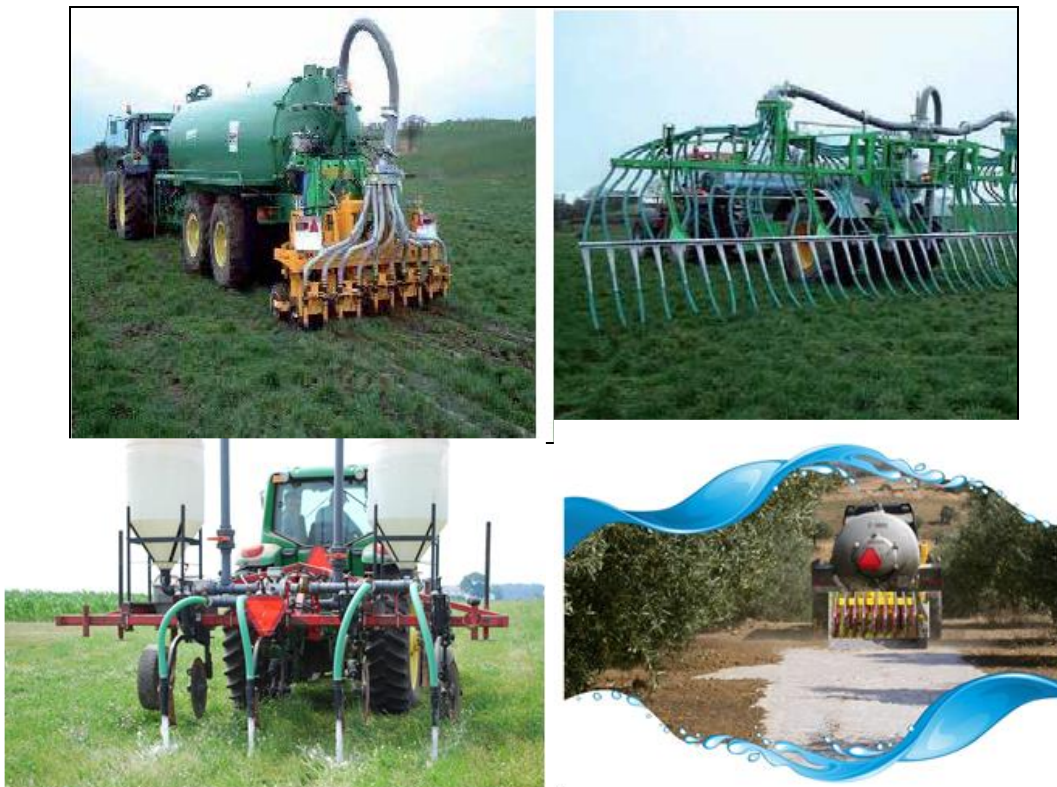
Fig. 26 - Equipamento de aplicação de chorume sobre a superfície a baixa pressão
